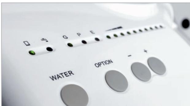
Il pannello comandi, collegato ad una scheda a microprocessore, permette di selezionare le funzioni Scaling, Endo e Perio. Semplice da utilizzare: tramite il pulsante "OPTION" è possibile scegliere la modalità di ablazione mentre i simboli "+" e "-" permettono di regolare l'intensità delle vibrazioni. L'intensità scelta sarà poi indicata nella barra LED a 10 livelli posta sull'ablatore. L'acqua/spray è regolabile tramite l'apposita manopola posta sull'ablatore.
